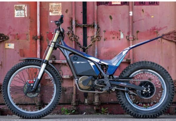
Schlanker geht's kaum: Die fehlende Auspuffanlage verbessert die Fahrzeugbalance, der Schalthebel macht die FACTOR-e in ihrem Segment einzigartig. Ein TFT mit Connectivity informiert über Mapping und Akkustand. Über einen optionalen Fingerhebel lässt sich die Motorbremse auf Abfahrten fein dosieren.
