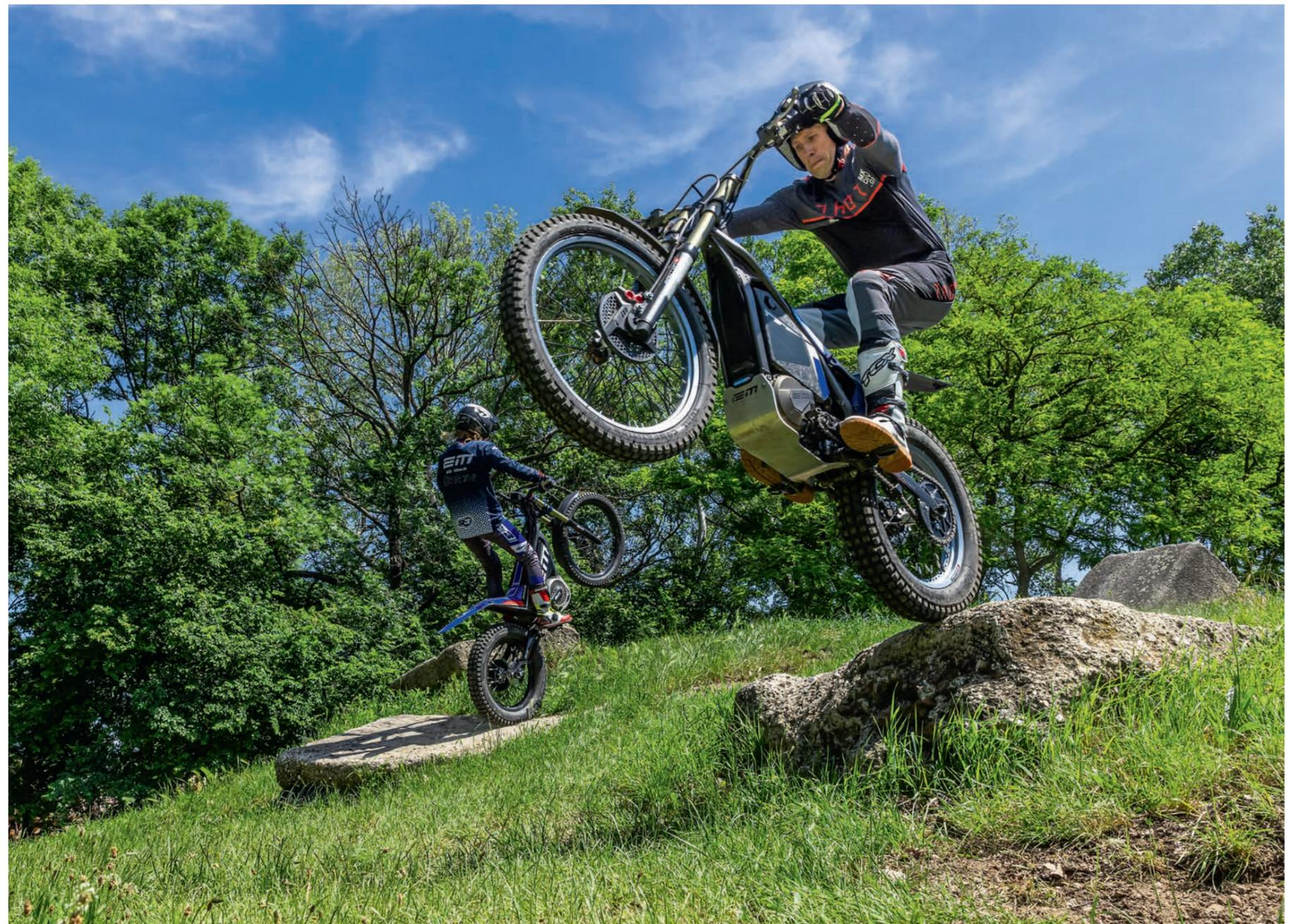
Mit Kupplung und 4-Gang-Getriebe muss die Electric Motion Epure FACTOR-e den Vergleich mit konventionellen Verbrenner-Trials keinesfalls scheuen – und stellt diese Tatsache aktuell auch in der Trial2-WM imposant unter Beweis.
